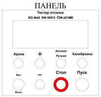
Электронное оборудование состоит из маятникового датчика угла. Сигналы датчика угла поступают на блок индикации, который рассчитывает значение отражения R от бампера в процентах.
