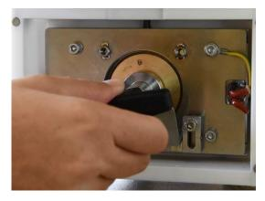
Установка упора – по толщине образца
