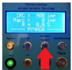
Tel: :+420 603 945 378 www.polymertest.cz kadlecek@polymertest.cz Оператор нажимает кнопку АВТОМАТ/РУЧНОЙ и переключается на РУЧНОЙ.
