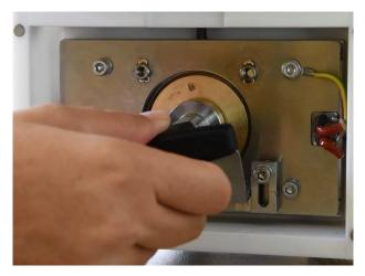
Установка упора – по толщине образца
