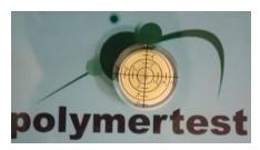
На устройство устанавливается спиртовой уровень. Используйте гаечный ключ, чтобы отрегулировать ножки.
