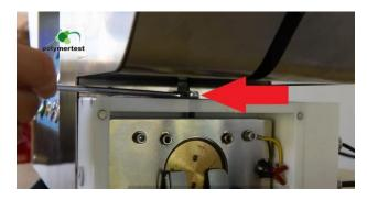
После регулировки осторожно затяните стопорный винт.
