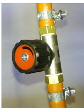
Otevře jehlový ventil, zapálí kahan a seřídí výšku plamene podle měrky.
